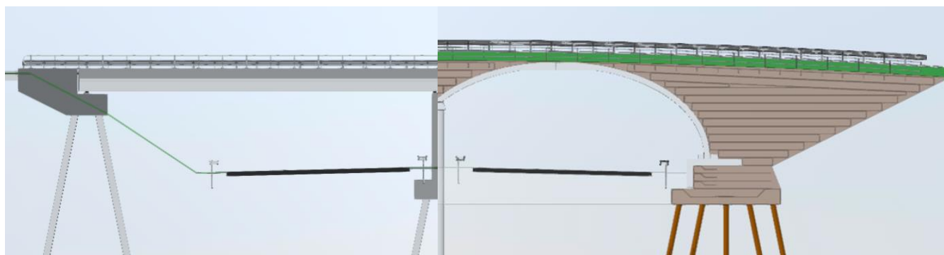
Afbeelding 2: Impact op basis van vergelijking tussen een traditioneel liggerviaduct en ons circulair viaduct
