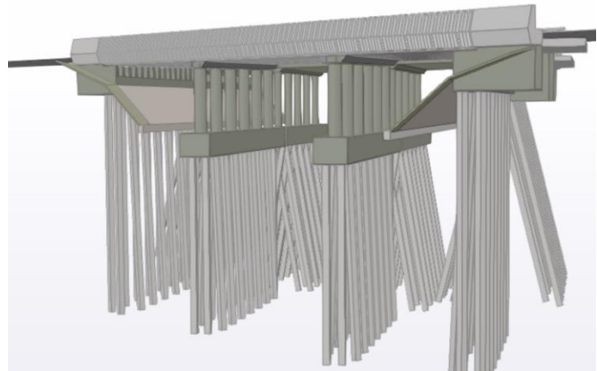
Figuur 3 - Traditioneel viaduct met paalfundering
