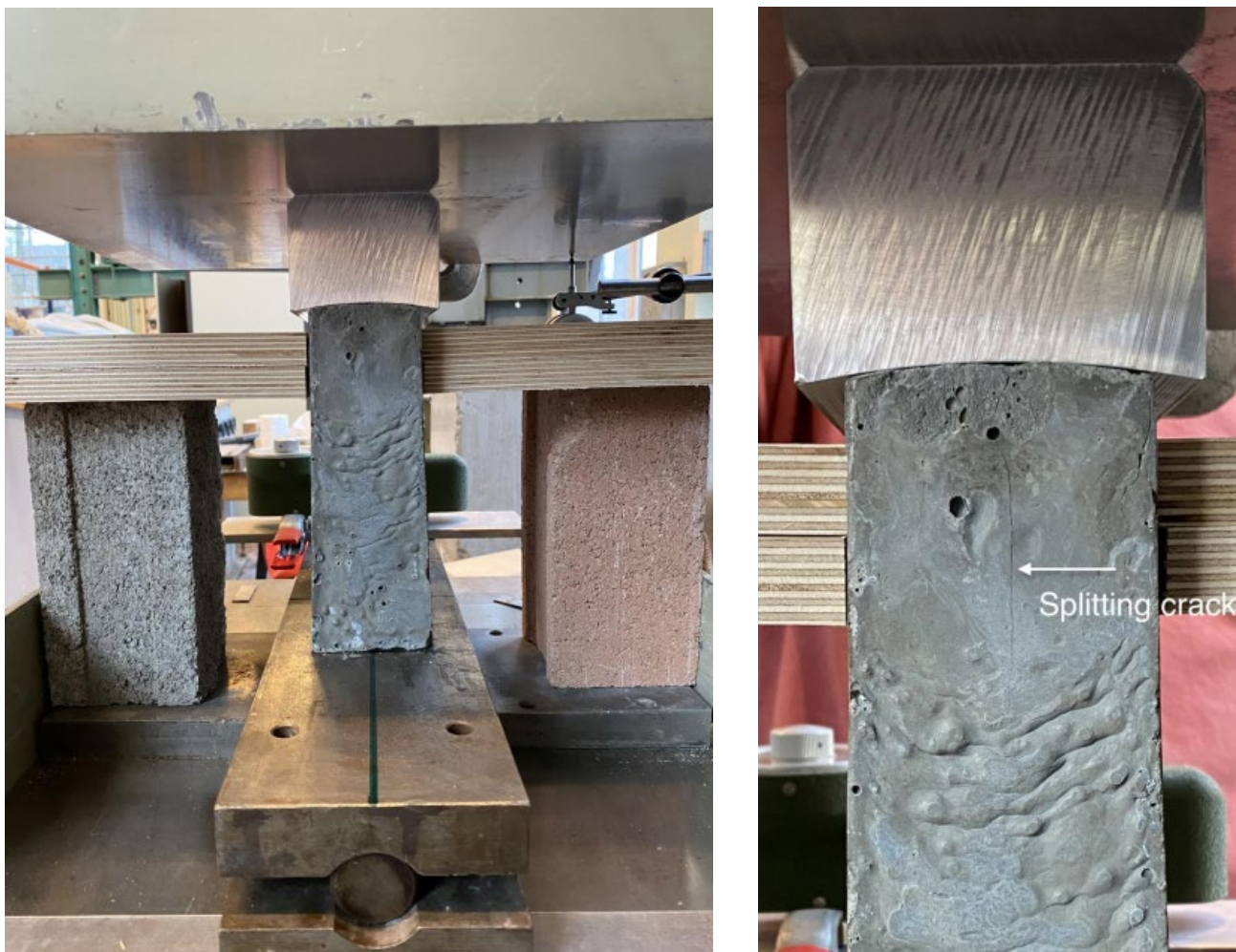
Figuur 6: Eerste laboratoriumtesten werden uitgevoerd op een proefstuk van het scharnierdetail op ware grootte.
